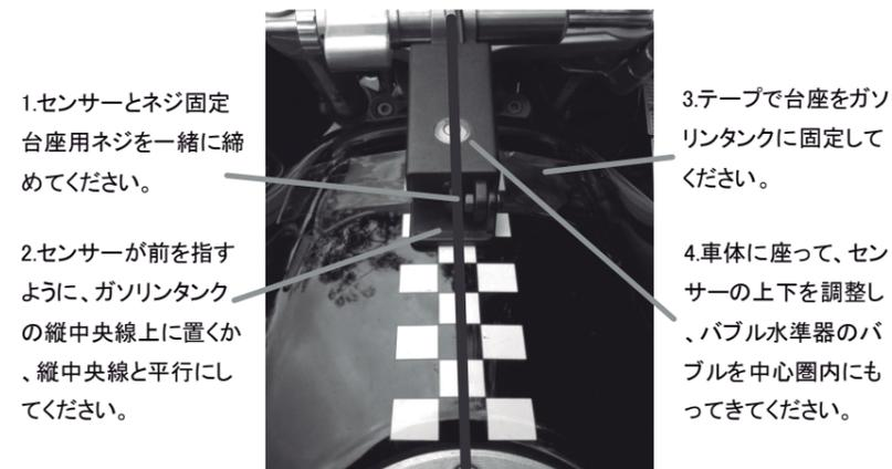
1. センサーとネジ固定台座用ネジを一緒に締めてください。
